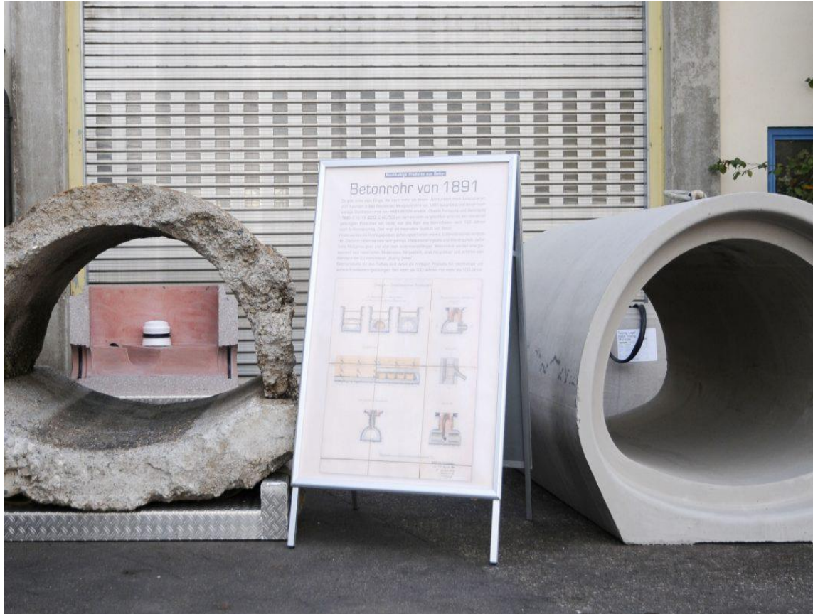
Betonrohre als Betonfertigteil, 1891 und heute
